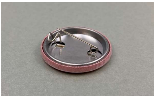
Abbildung 1 Verbogene Befestigung zur Seite
