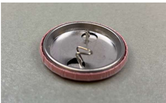
Abbildung 3 Verbogene Befestigung nach hinten
